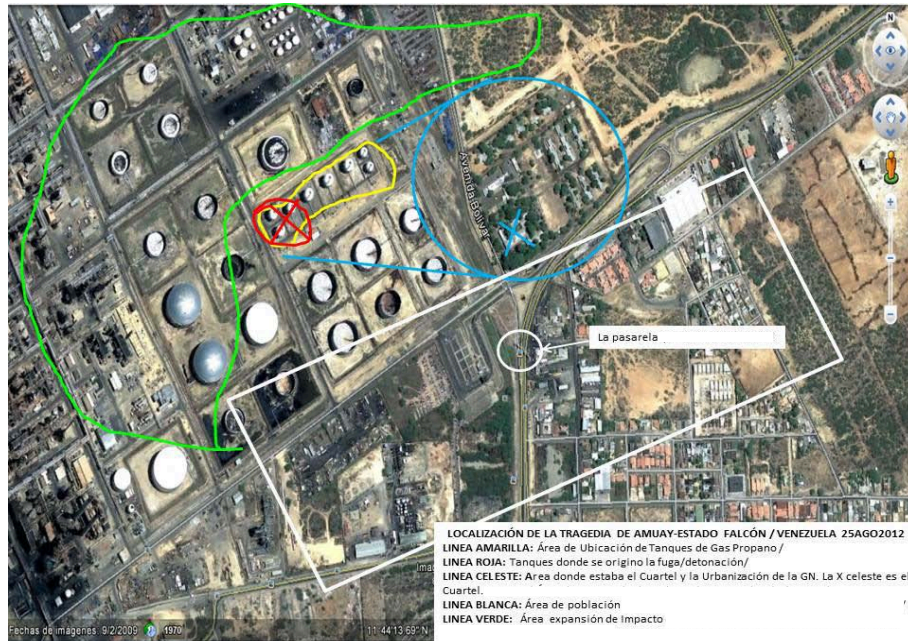
Foto e.3: área de almacenamiento y zonas externas afectadas
