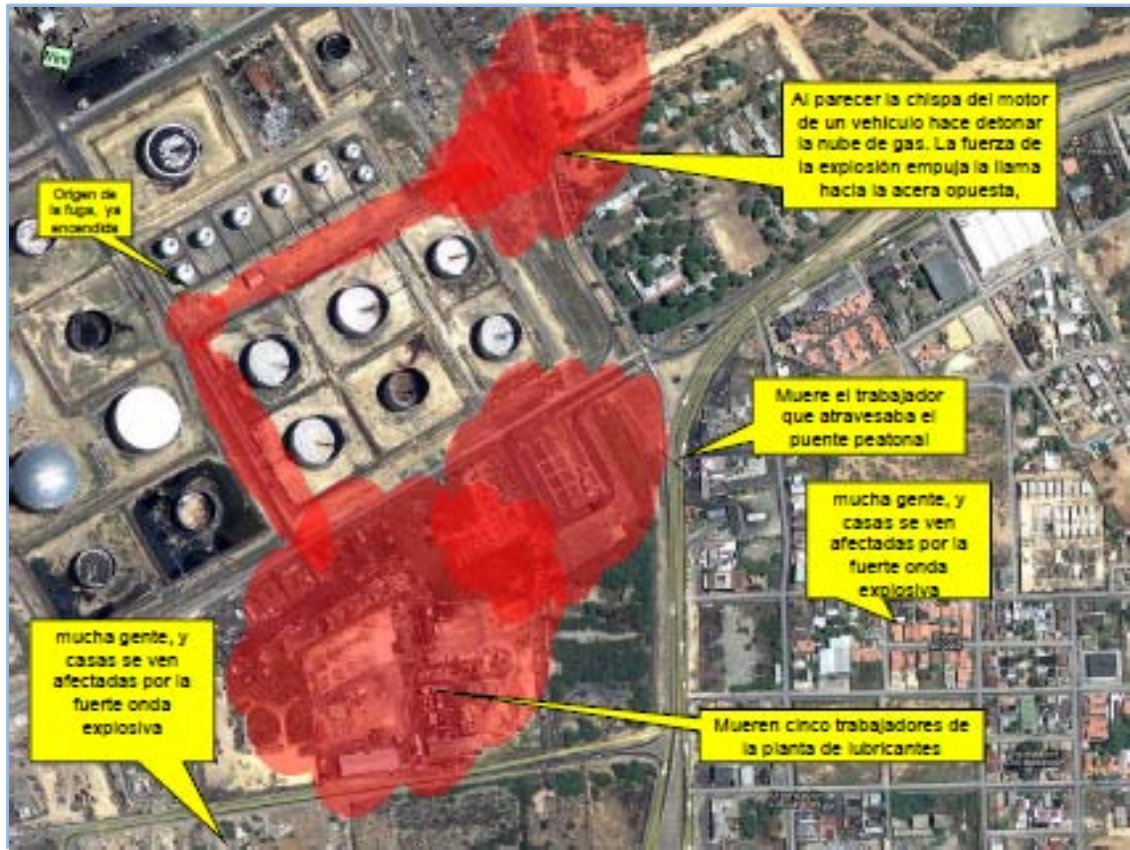
Figuraf.1:Posible propagación fuga gas en bloque 23 Refinería Amuay.
